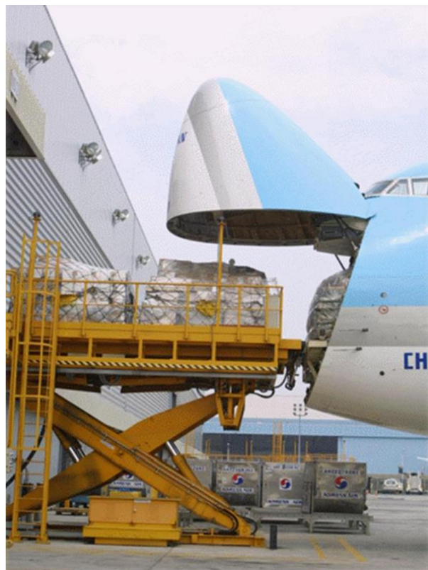
Slika 19. Ukrcaj robe u zrakoplov preko nosnih vrata, [16]
