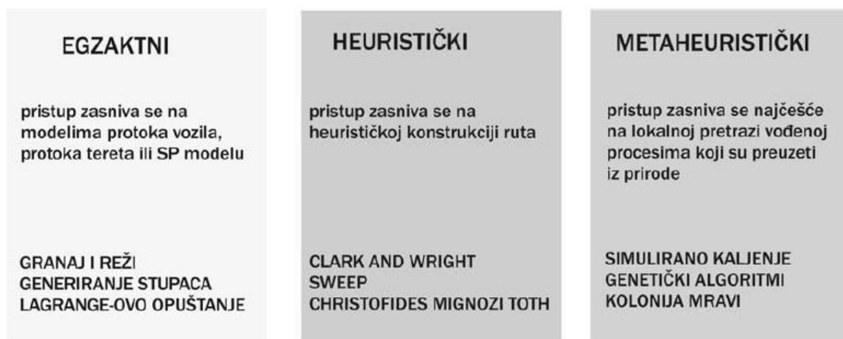
Slika 2. Pristupi rješavanju problema usmjeravanja vozila
