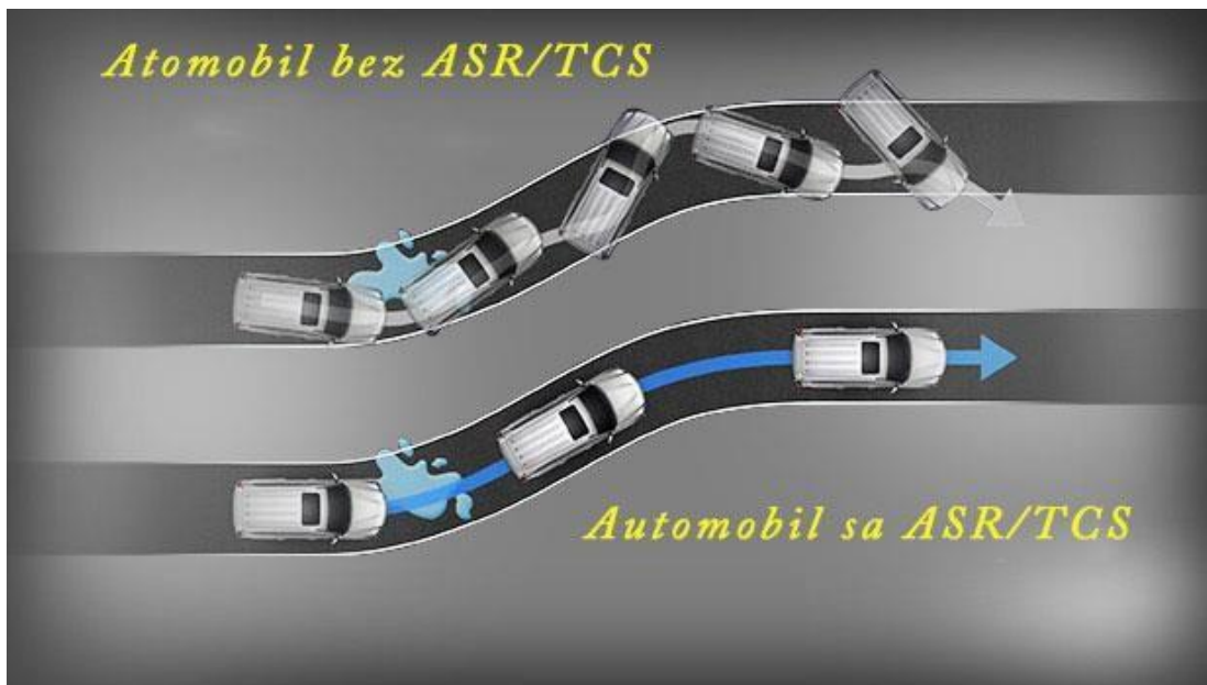
Slika 15. Prikaz značenja kad vozilo posjeduje TCS/ASR sistem
