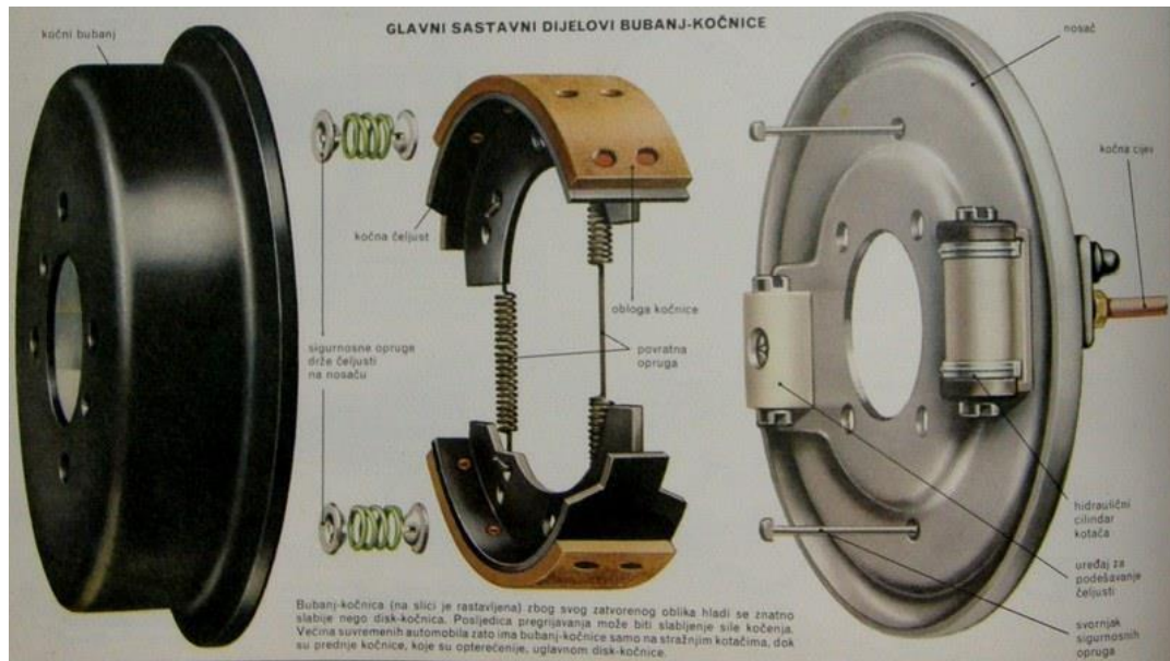
Slika 4. Glavni sastavni dijelovi bubanj - kočnice
