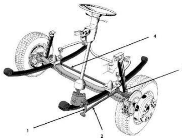
Slika 42. Upravljački sustav s pužnim prijenosnikom kod teretnih vozila
