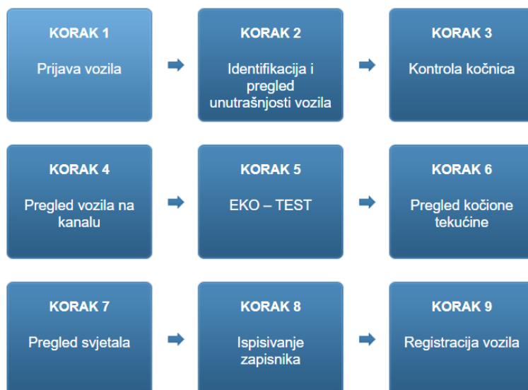
Slika 64. Proces obavljanja tehničkog pregleda vozila
