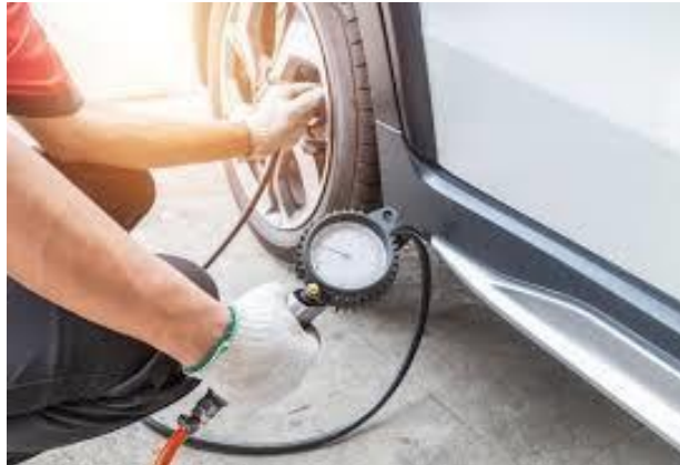
Slika 77. Mjerenje tlaka u pneumaticima manometrom
