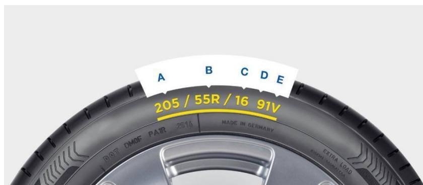
Slika 19. Oznake na pneumatiku
