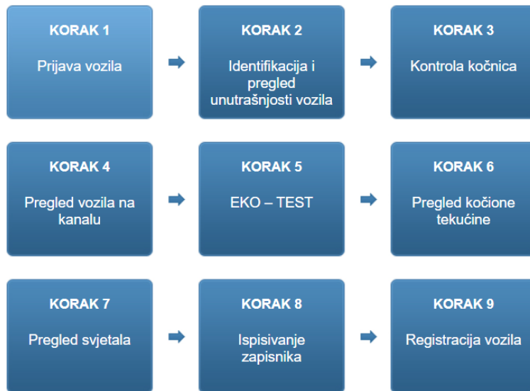
Slika 64. Proces obavljanja tehničkog pregleda vozila
