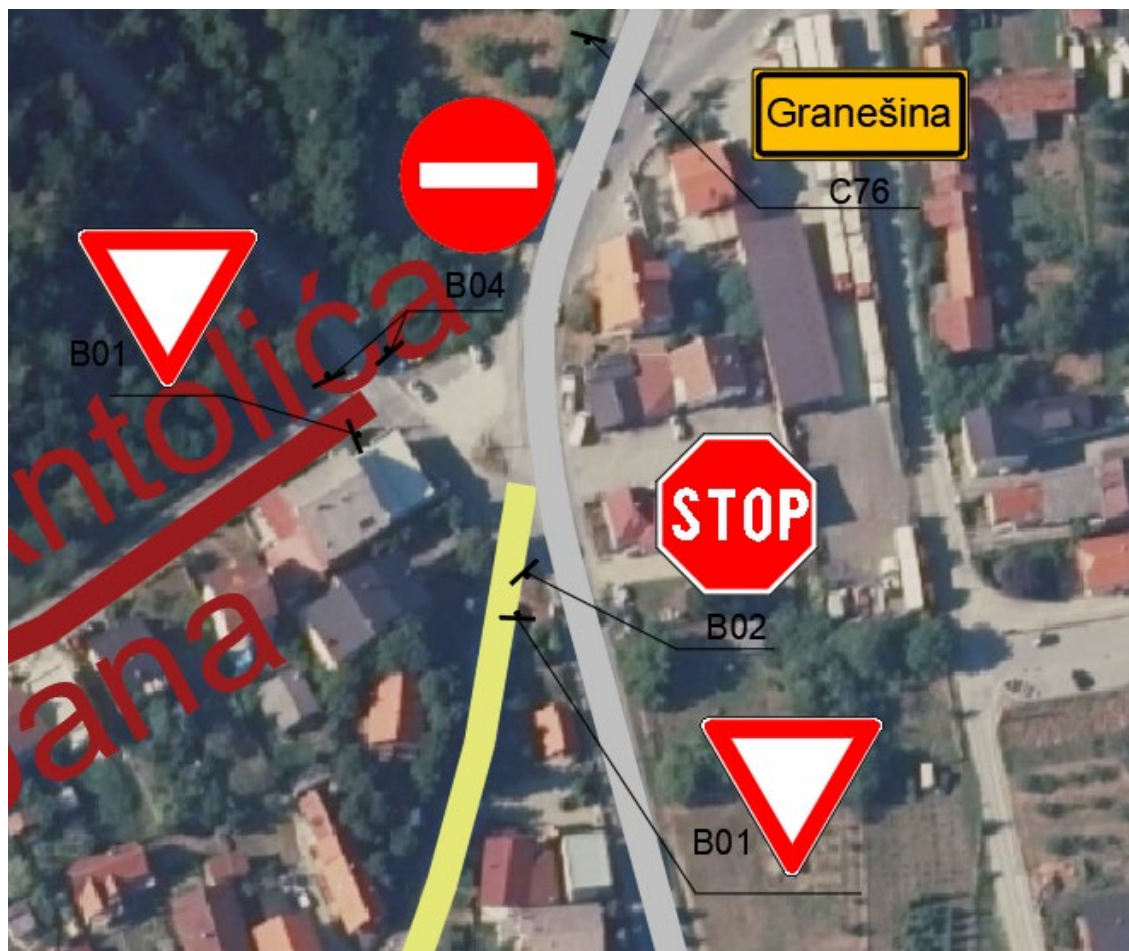
Slika 43. Postavljeni prometni znakovi na raskrižju Sunekove ulice, ulice Filipa Antolića Sobana i Goričanci ulice
