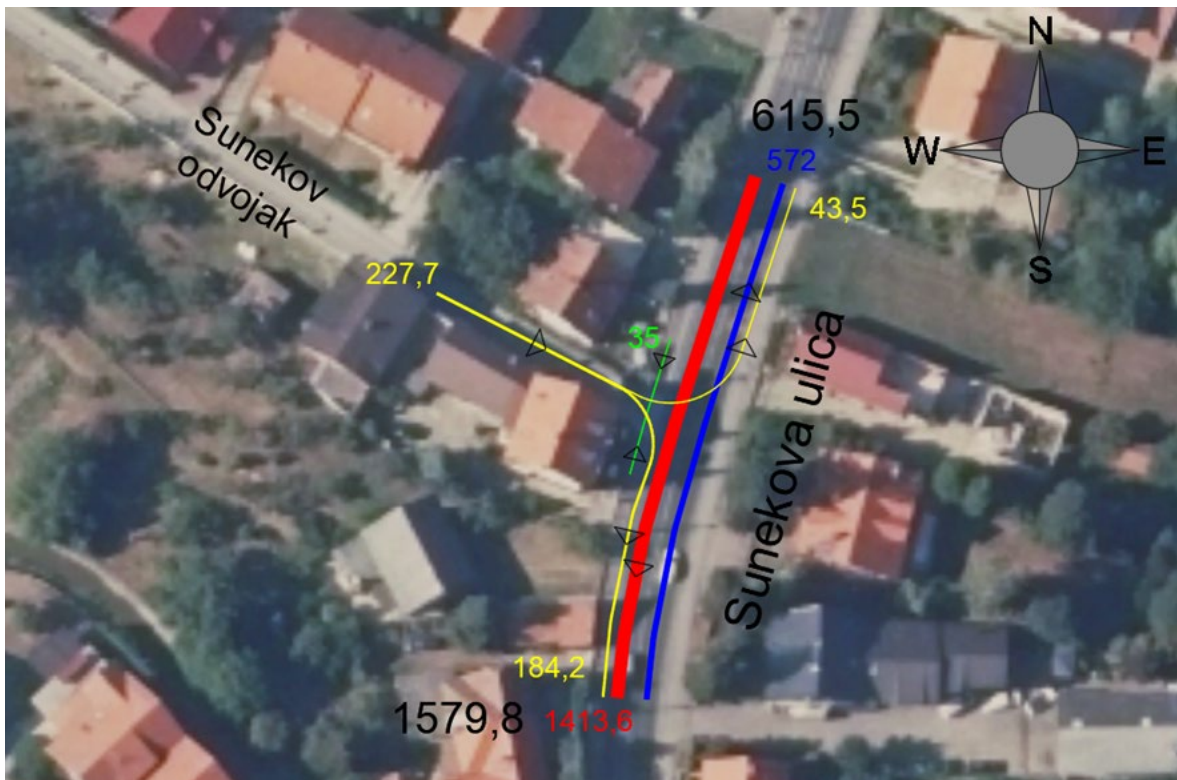
Slika 23. Grafički prikaz jutarnjeg vršnog prometnog opterećenja na raskrižju Sunekova ulica i Sunekov odvojak
