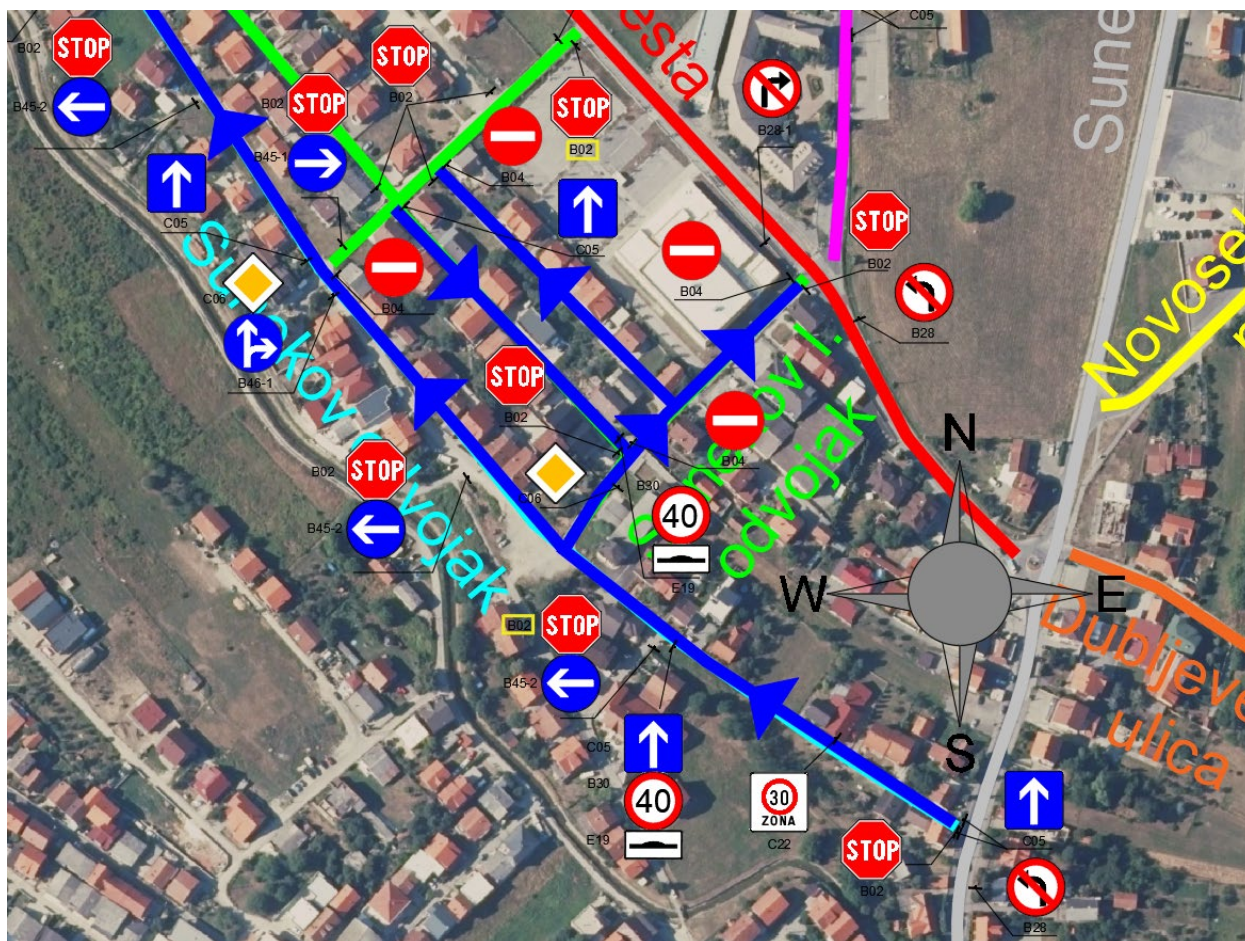
Slika 79. Novo postavljena vertikalna prometna signalizacija na Sunekovom odvojkju, Sunekovo I. odvojkju, Sunekovoj ulici i Miroševečkoj cesti
