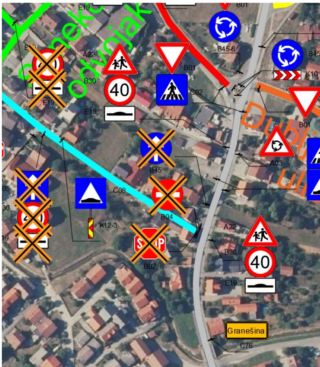
Slika 76. Prometni znakovi koje je potrebno ukloniti
