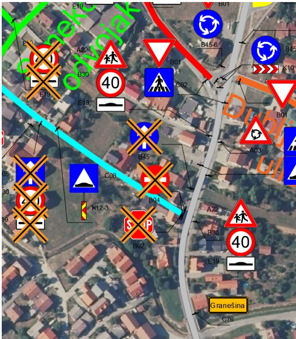
Slika 76. Prometni znakovi koje je potrebno ukloniti
