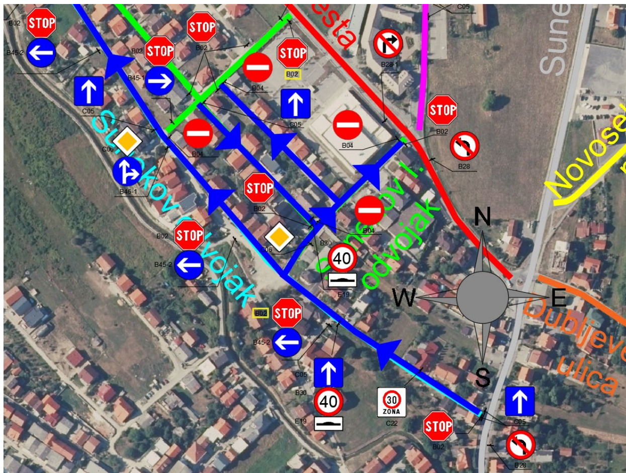
Slika 79. Novo postavljena vertikalna prometna signalizacija na Sunekovom odvojkju, Sunekovo I. odvojkju, Sunekovoj ulici i Miroševičkoj cesti
