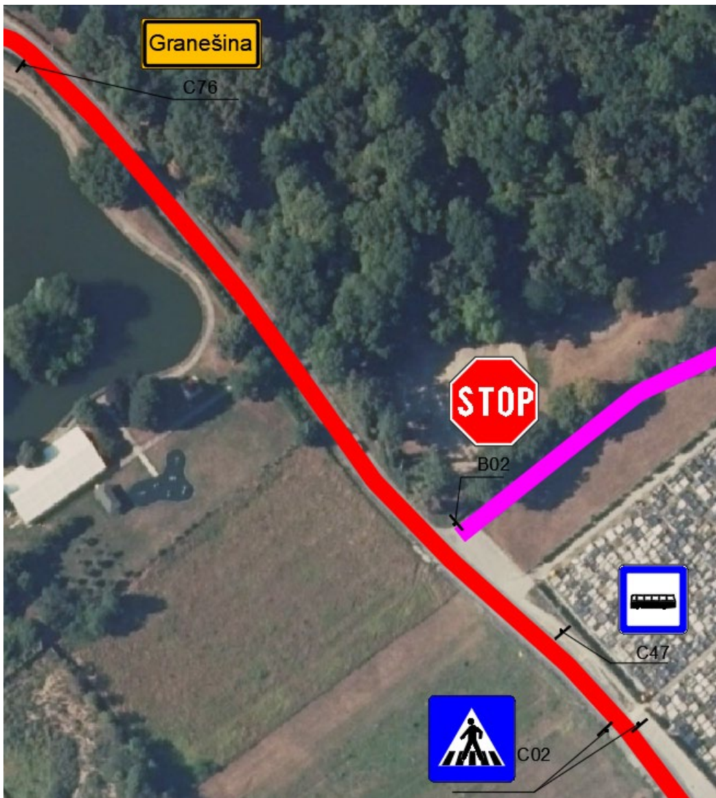
Slika 46. Postavljeni prometni znakovi na križanju Miroševčke ceste i Granešine ulice
