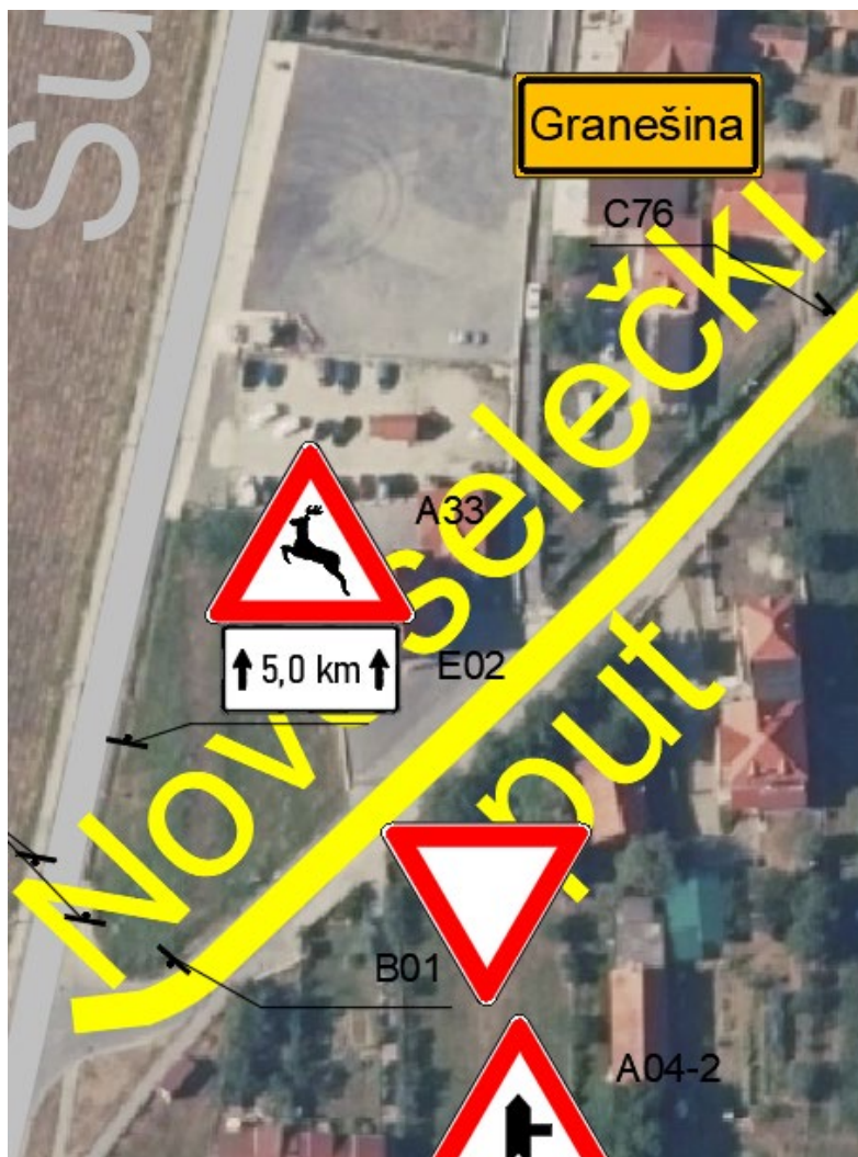
Slika 42. Postavljeni prometni znakovi na Novoselečkom putu
