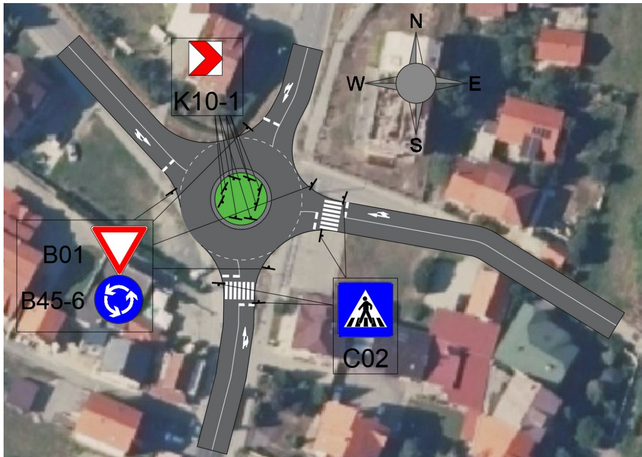
Slika 86. Prijedlog rekonstrukcije postojećeg kružnog toka
