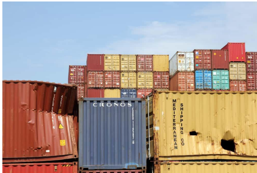
Slika 3 Oštećenje kontejnera pri manipulaciji [6]
