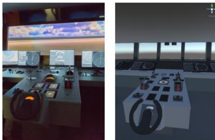
Slika 25. CAVE sustav (lijevo) i HMD sustav (desno) Izvor: [45]
