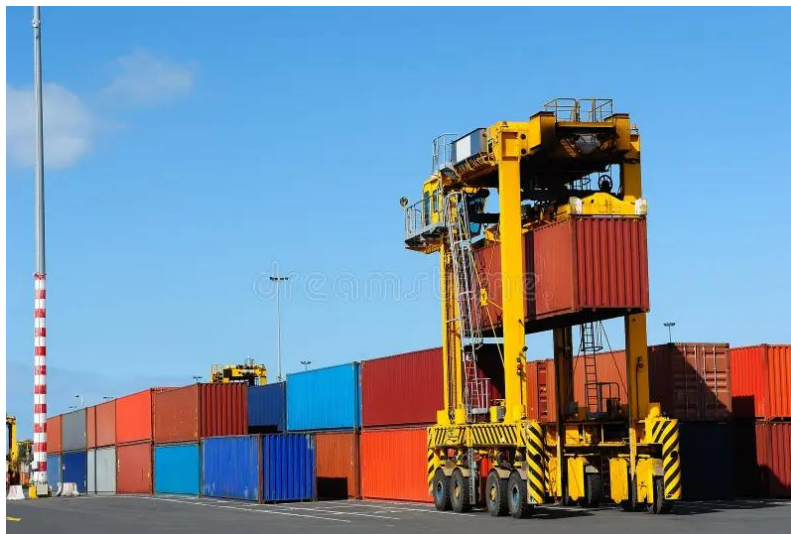
Slika 3. Portalni prijenosnik malog raspona Izvor: [7]
