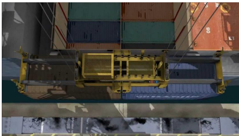
Slika 29. Simulacija hvatača na obalnoj dizalici Izvor: [45]
