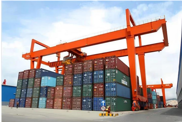
Slika 4. Portalni prijenosnik velikog raspona Izvor: [8]
