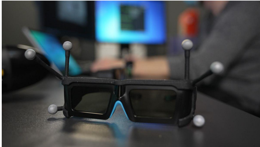
Slika 22. Stereo naočale za CAVE sustav Izvor: [42]
