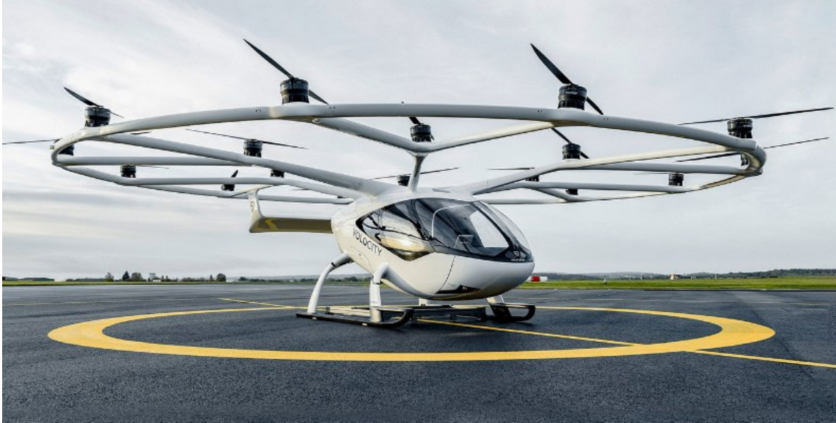
Slika 9. Volocopter, VoloCity - primjer multikoptera Izvor: [34]
