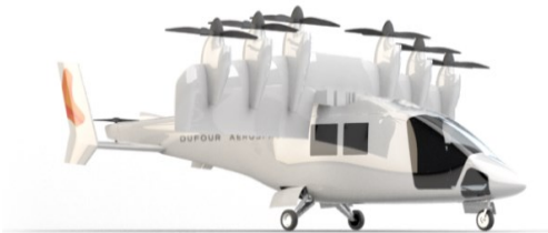
Slika 11. Dufour Aero 3 - tilt wing Izvor: [37]
