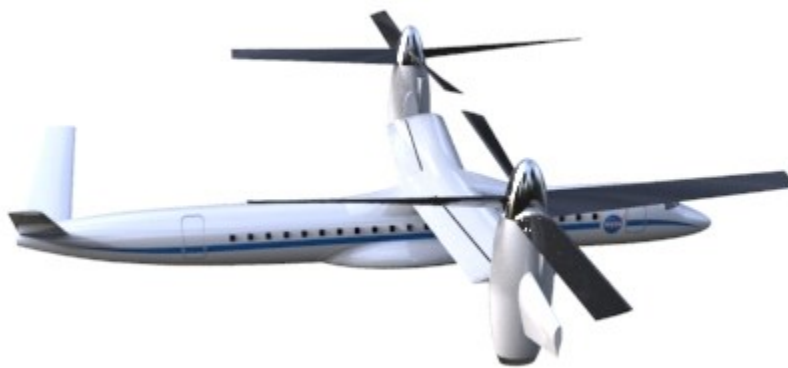
Slika 7. NASA veliki civilni tiltrotor Izvor: [26]
