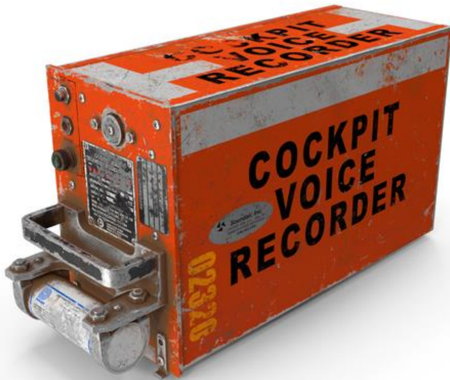
Slika 9. Standardni CVR uređaj Izvor: [16]
