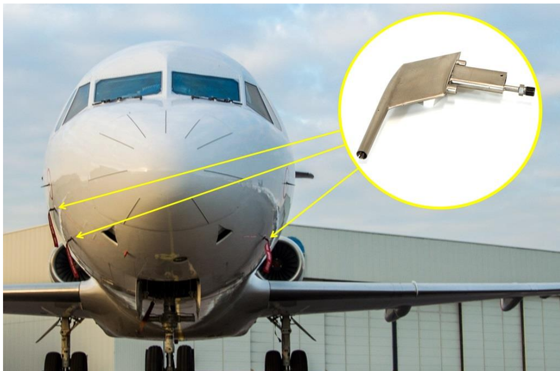
Slika 15. Položaj pitot-cijevi u zrakoplovu Izvor: [38]
