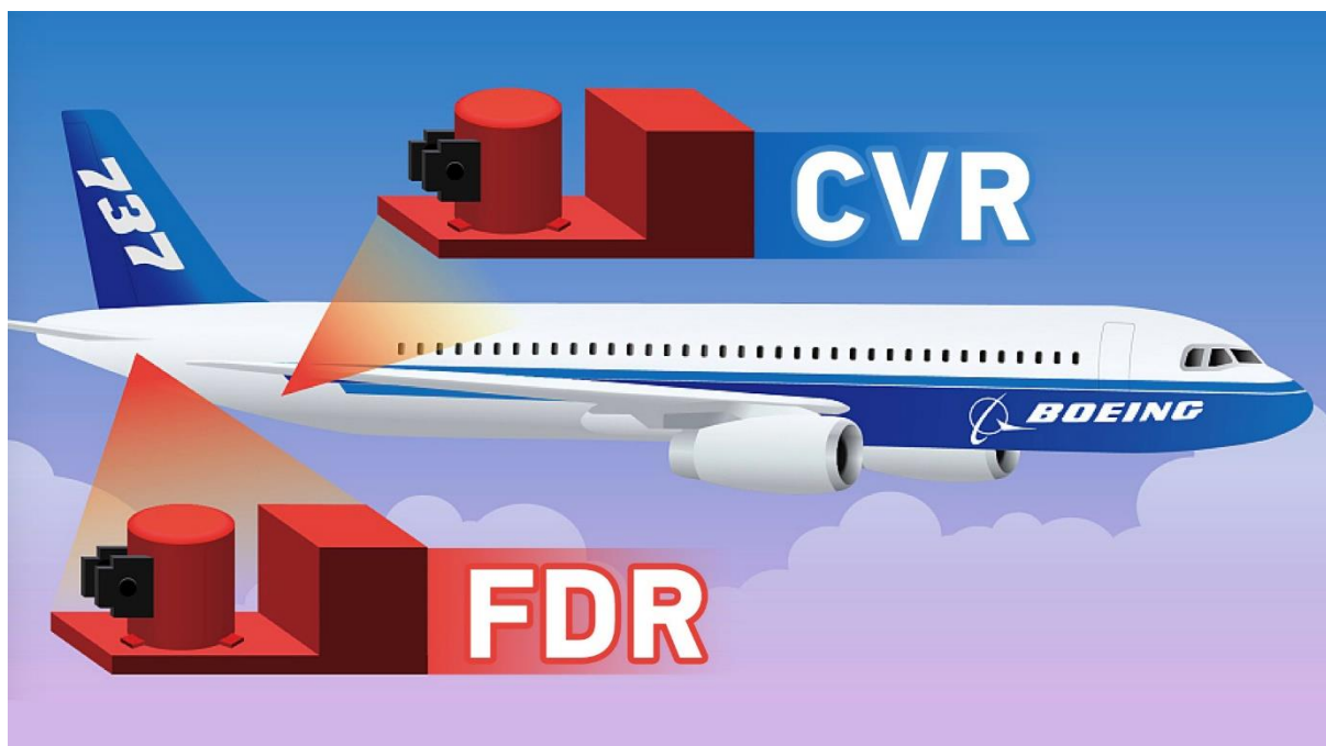
Slika 10. Lokacija uređaja za snimanje leta u zrakoplovu Izvor: [7]
