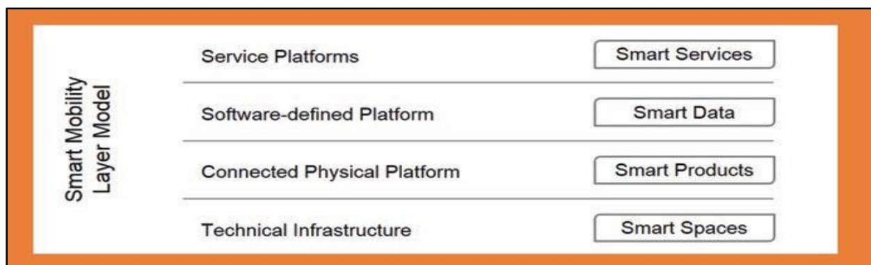
Slika 5. Model pametne mobilnosti u slojevima. Izvor: [5]
