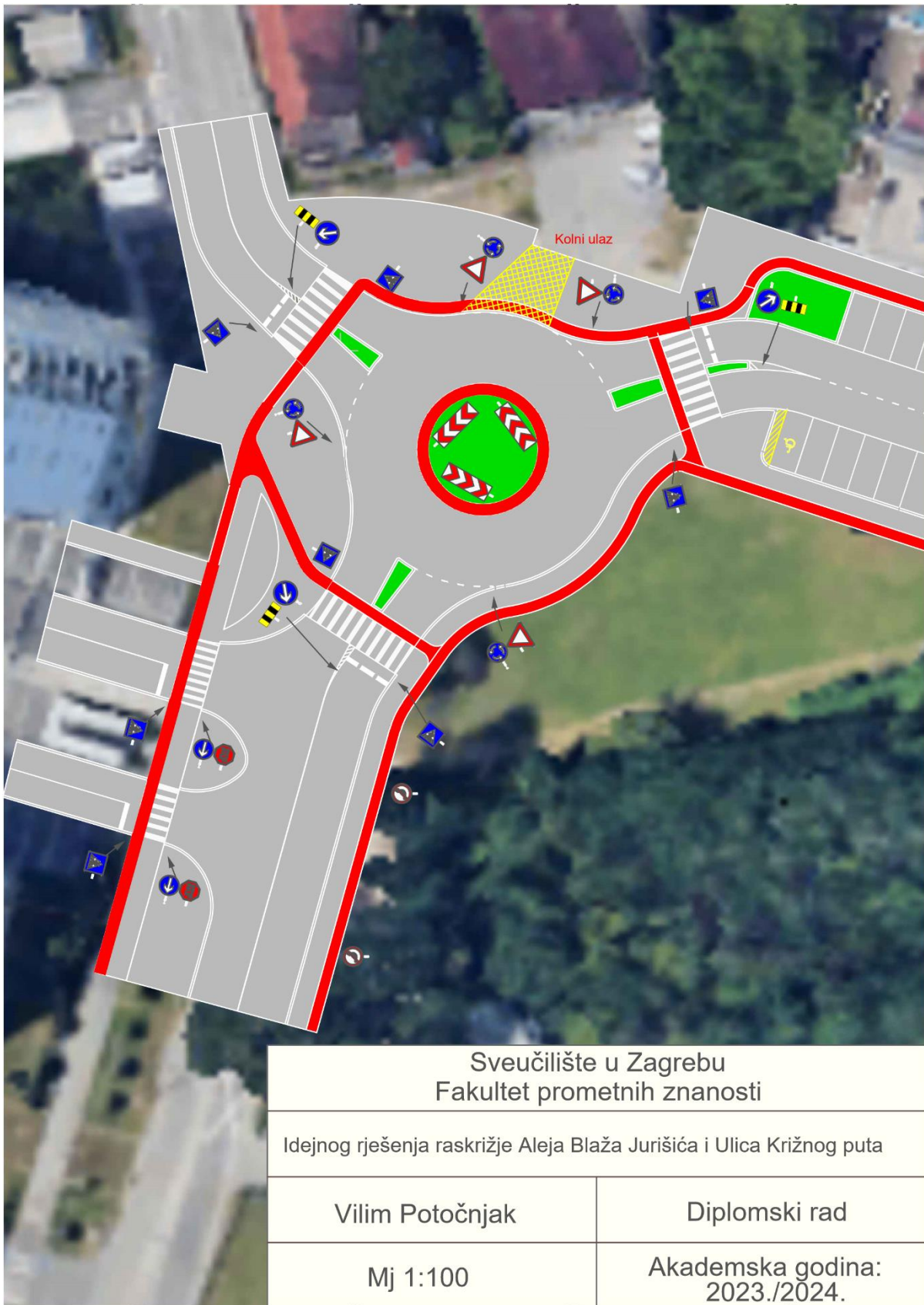
Slika 30. Prikaz idejnoga rješenja raskrižje Aleja Blaža Jurišića i Ulica Križnog puta u programskom alatu AutoCad.
