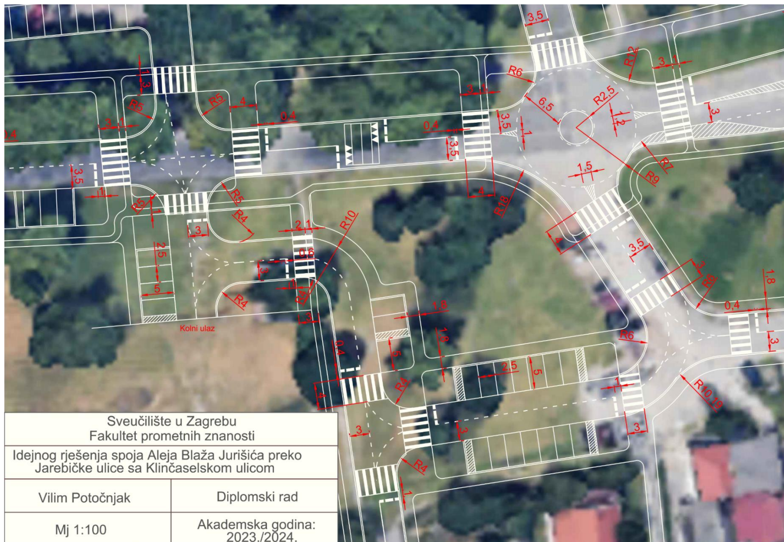
Slika 48. Prikaz s kotama idejnog idejnog rješenja spoja Aleja Blaža Jurišića preko Jarebičke ulice sa Klinčaselskom ulicom u programskom alatu AutoCad, izvor: Izradio Autor,
