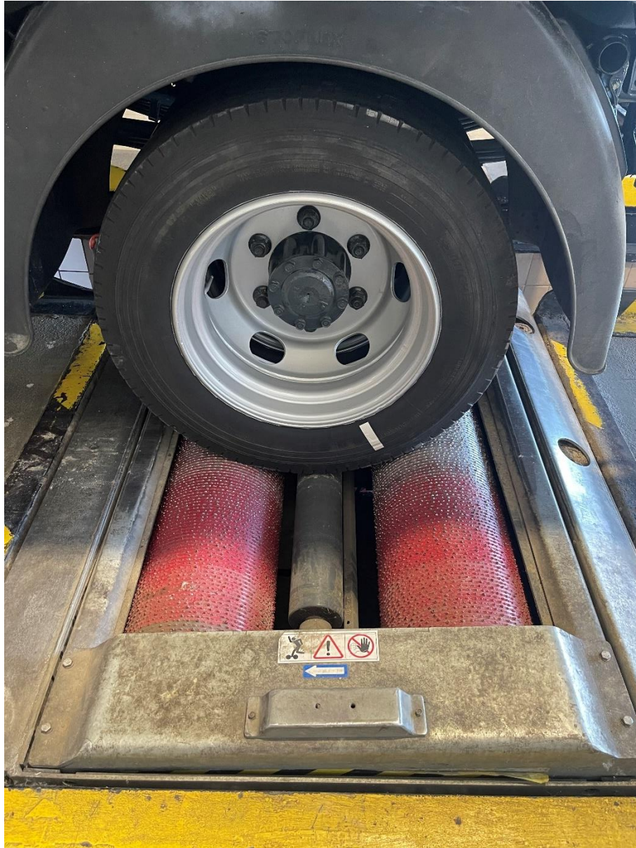
Slika 11. Prikaz mjerenja opsega kotača pomoću ispitnih valjaka
