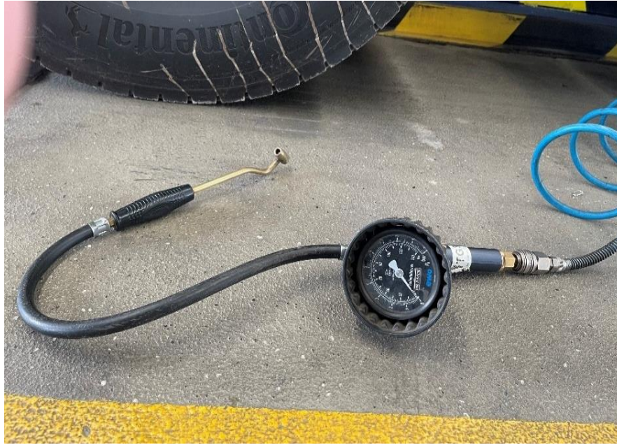
Slika 9. Prikaz manometra korištenog za regulaciju tlaka zraka u pneumaticima
