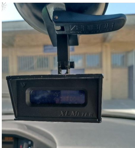
Slika 10. Pozicija XL Meter TM pro uređaja u vozilu Citroen C6 tijekom provedbe istraživanja
