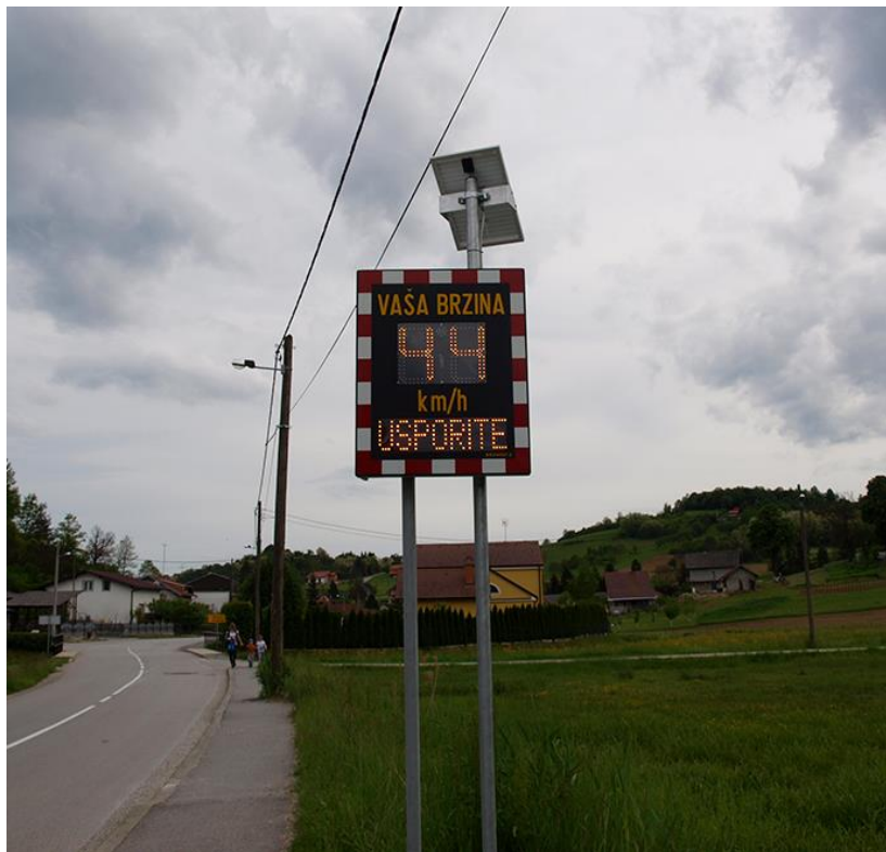
Slika 29. Preventivni radarski mjerač Izvor:[3]
