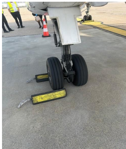
Slika 10. Prikaz ispravno postavljenih podmetača i čunjeva
