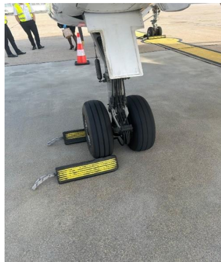
Slika 10. Prikaz ispravno postavljenih podmetača i čunjeva
