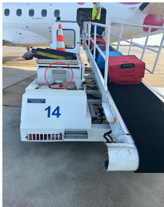
Slika 8. Prikaz koša za FOD na vozilu za istovar prtljage
