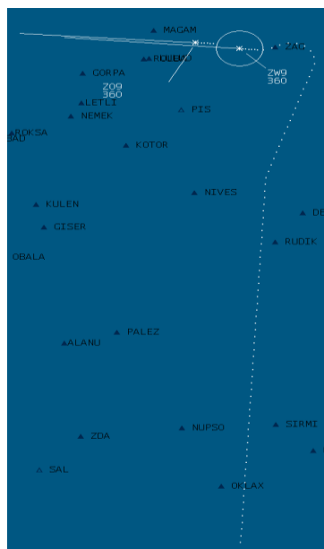
Slika 30: Putanja zrakoplova razdvajanjem metodom vektoriranja i prikaz povratka na točku ZAG nakon vektoriranja
