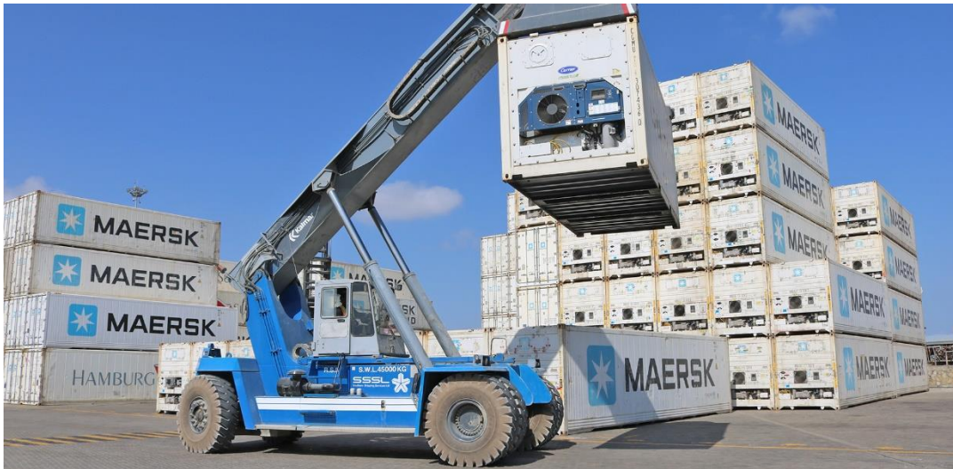
Slika 27. Prikaz rada kontejnerskog viličara u manipulaciji kontejnera hladnjača
