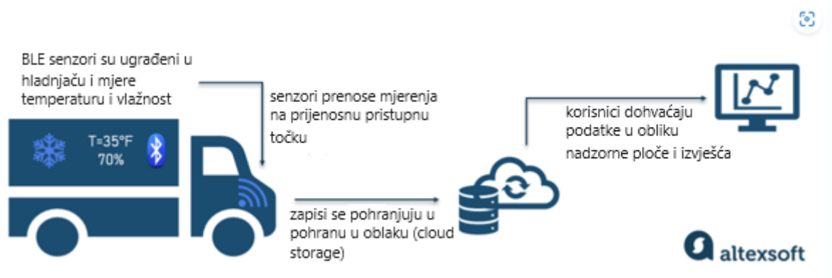
Slika 14. Princip rada IoT tehnologije u hladnom lancu, [8]
