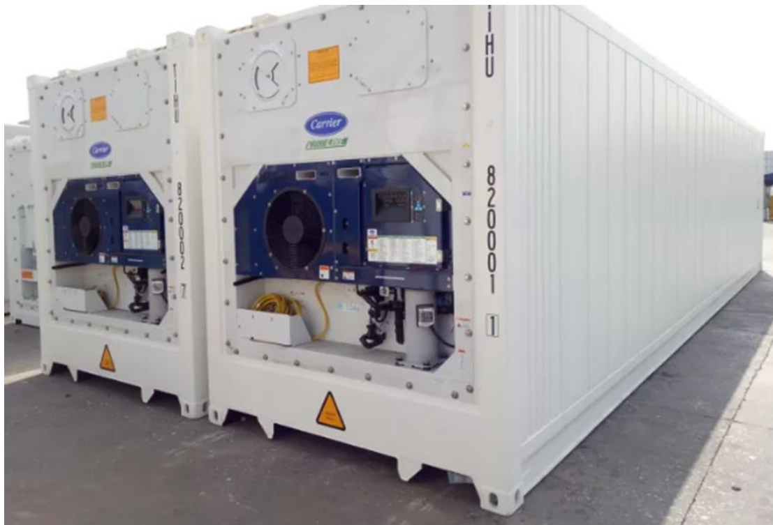
Slika 10. 40 stopni rashladni kontejner, [5]
