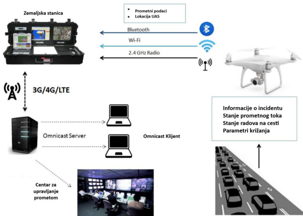
Slika 11 - Princip rada sustava bespilotnih letjelica za nadzor prometa
