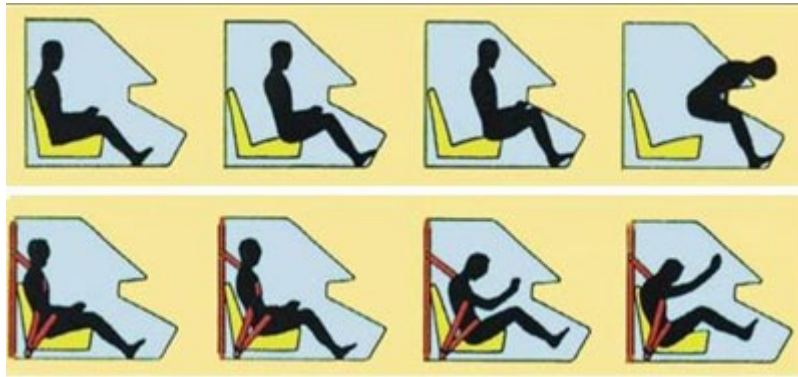
Slika 8. Kretanje tijela vozača prilikom sudara sa i bez sigurnosnog pojasa
