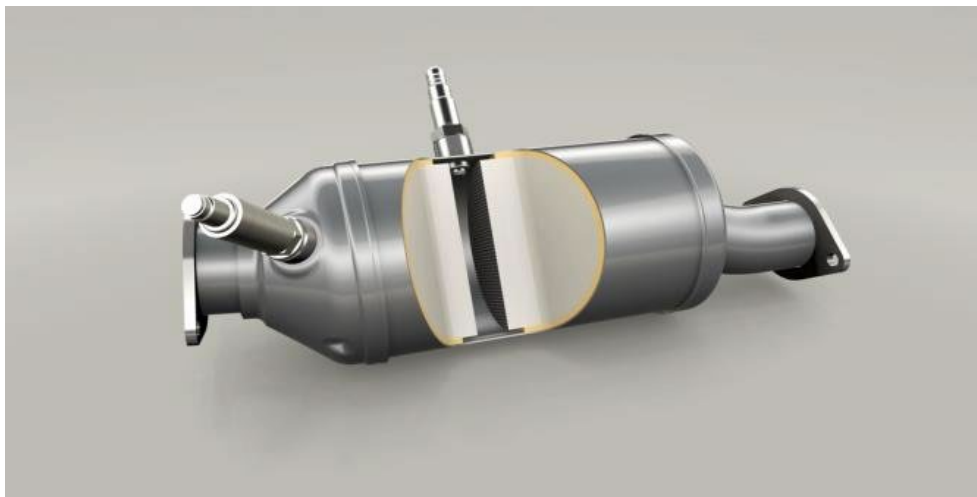
Slika 6. Presjek GPF filtera
