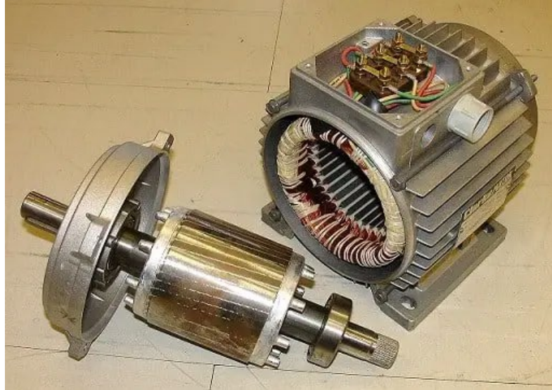
Slika 18. Rotor i stator indukcijskog motora
