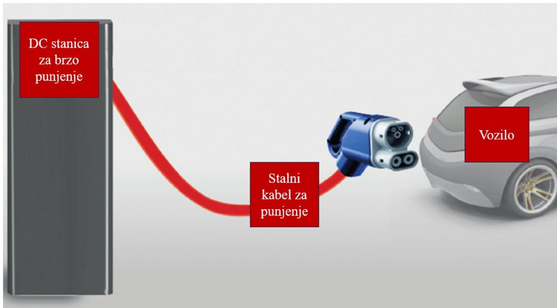
Slika 33. DC punjenje s brzim punjačem
