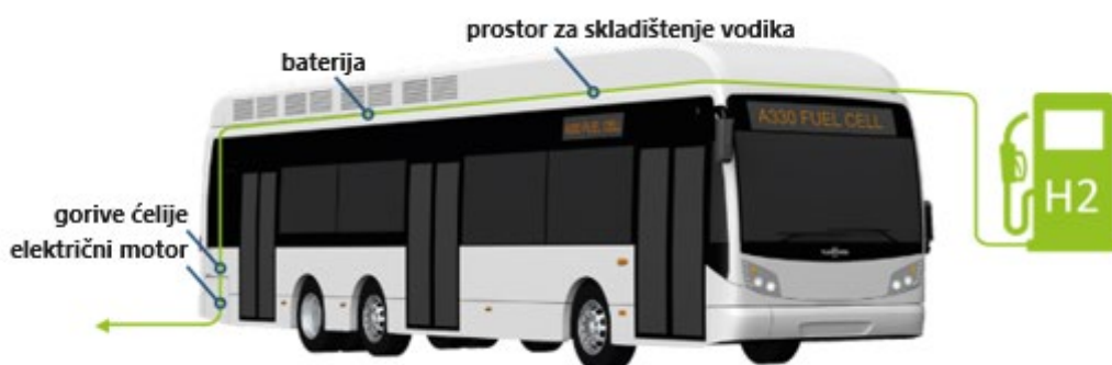
Slika 15. Elementi autobusa na gorive ćelije
