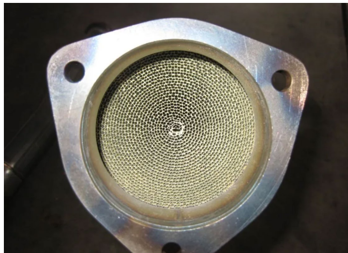
Slika 8. Prikaz unutrašnjosti katalizatora
