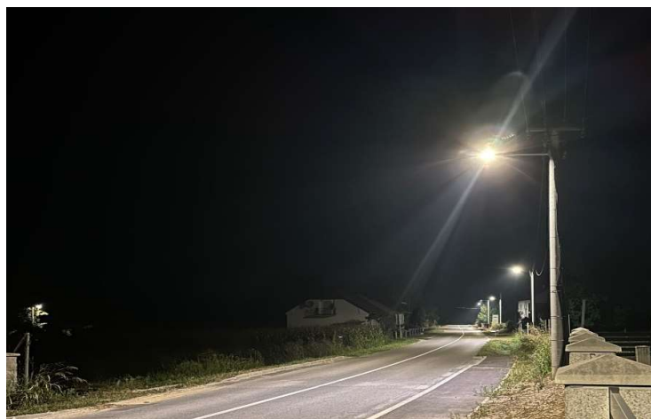
Slika 5. Jednostrani raspored izvora svjetlosti
