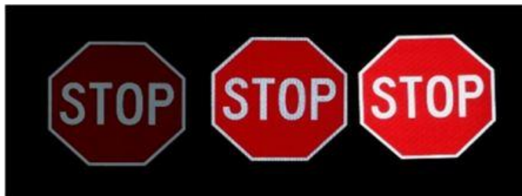
Slika 7. Prometni znak STOP izrađen od sve tri klase materijala
