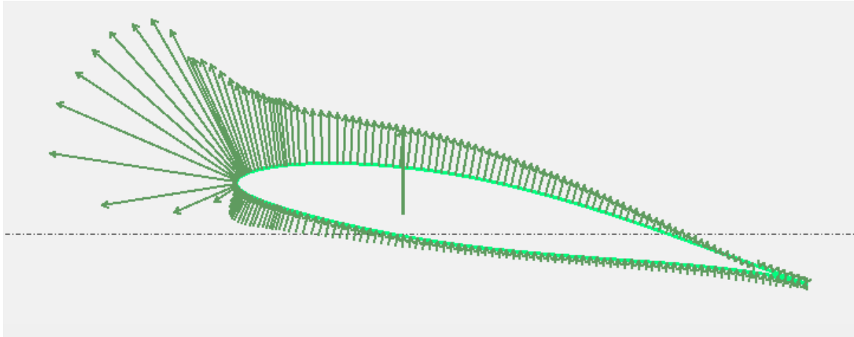
Slika 18. Prikaz rasporeda tlaka modificiranog aeroprofila NACA 63 1 -412
