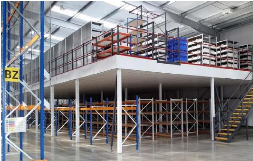
Slika 2. Primjer katnog (etažnog) skladišta
