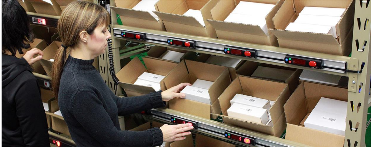
Slika 13. Pick by light komisioniranje
