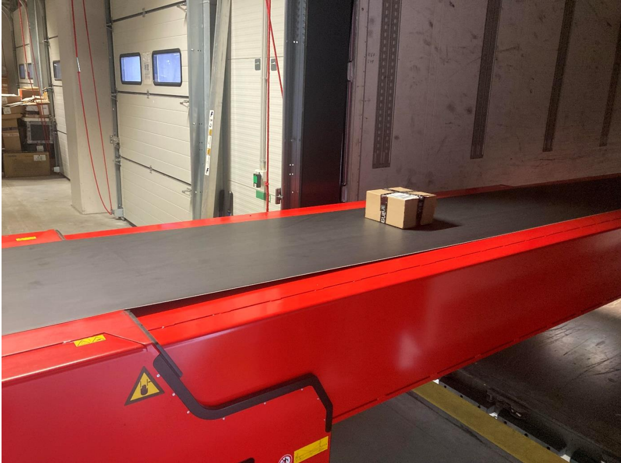
Slika 12. Pokretna traka koja se koristi pri prijemu pošiljki
