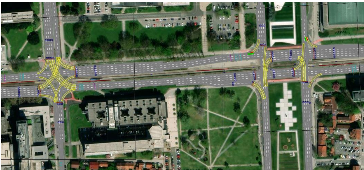
Slika 70. Prikaz dijela mreže izrađene simulacije za analizirani koridor
