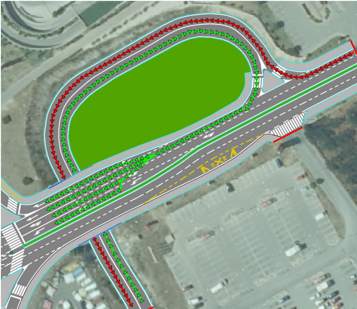
Slika 23. Kombinirano raskrižje na privozu D8 – istok
