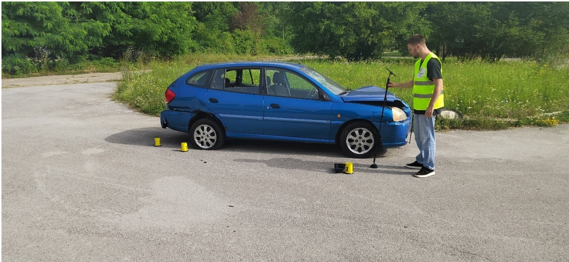
Slika 32. Prikaz korištenja uređaja za mjerenje na temelju senzora pokreta, "Moasure One Pro" uređaja
