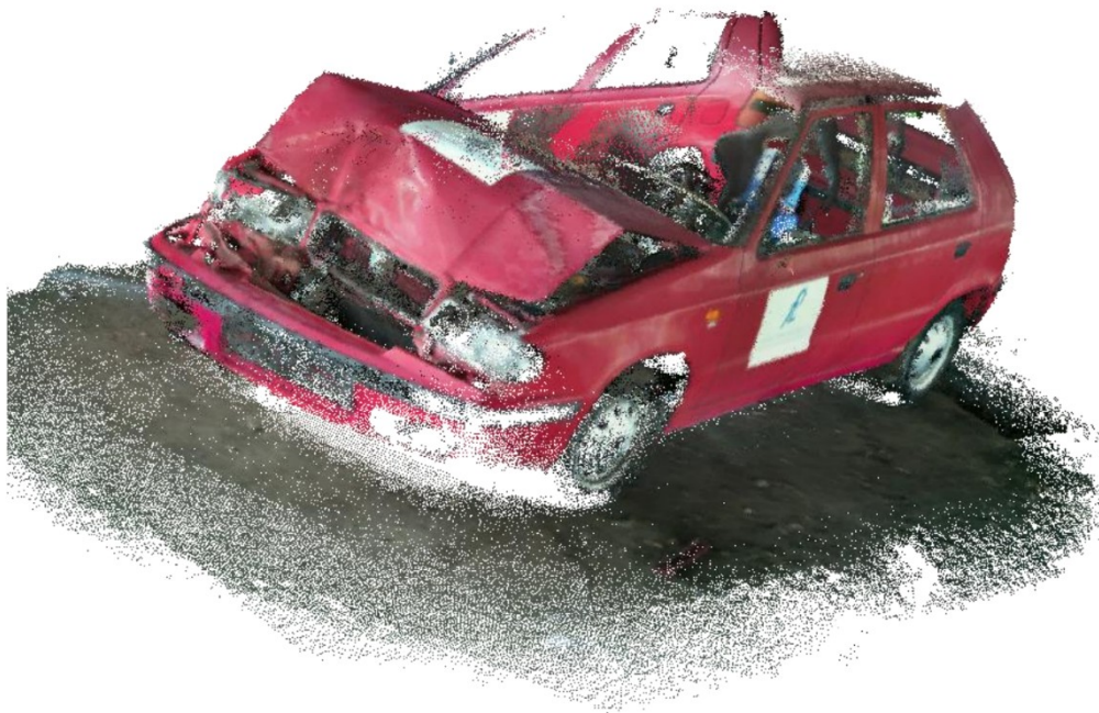
Slika 14. Prikaz 3D modela izrađen pomoću LiDAR kamere [10]
