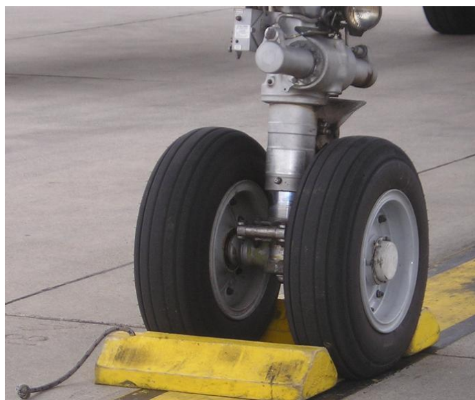
Slika 23. Primjer podmetača pod kotačima podvozja.
