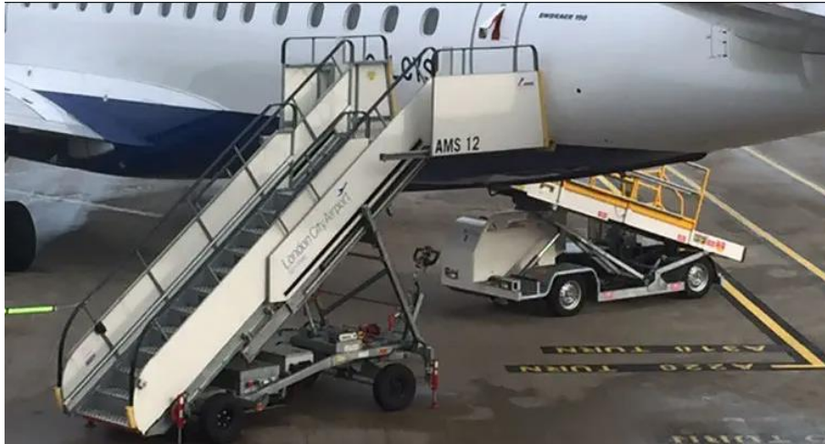
Slika 13. Primjer vučenih stepenica.
