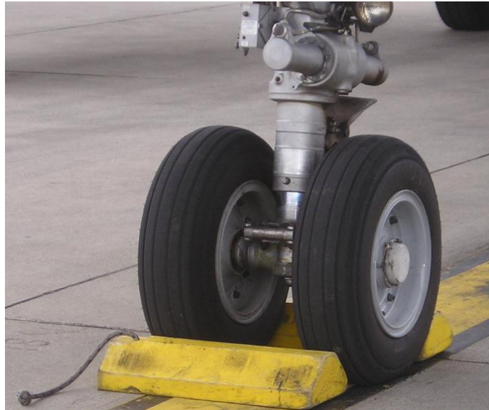
Slika 23. Primjer podmetača pod kotačima podvozja.
