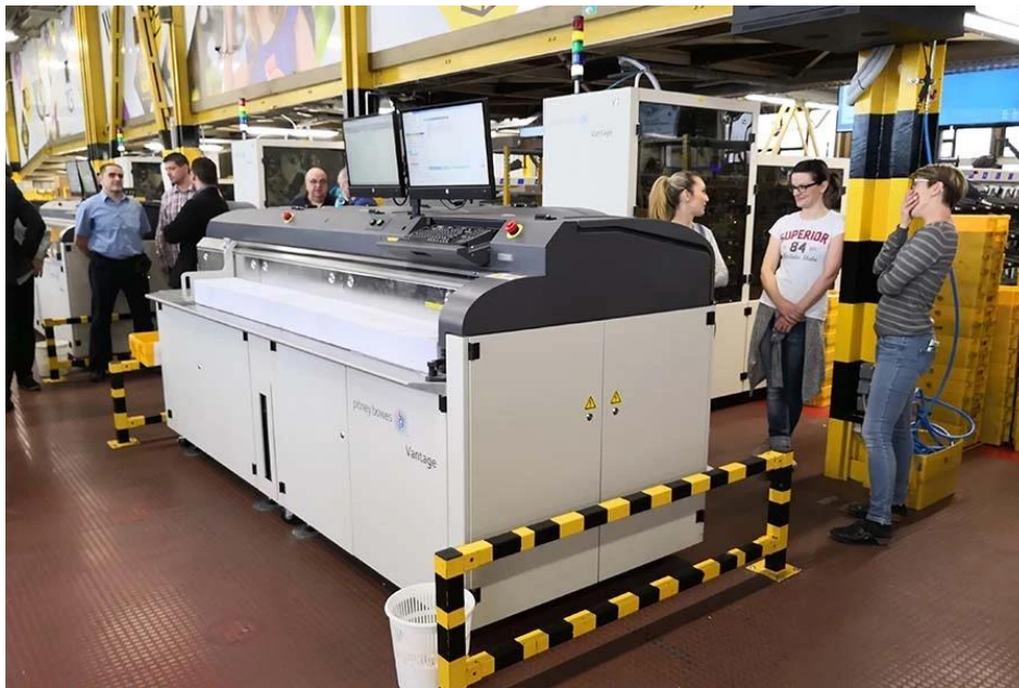
Slika 3. Sortirni uređaj Hrvatske pošte
