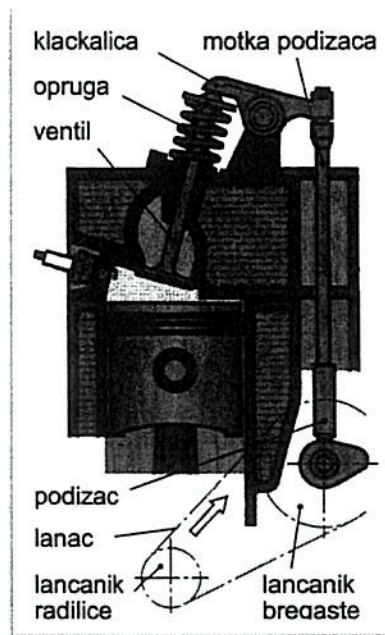
Slika 11 prikaz donjeg razvoda OHV motora
