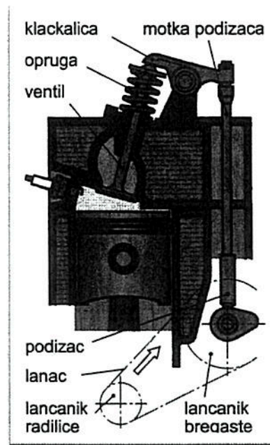
Slika 11 prikaz donjeg razvoda OHV motora
