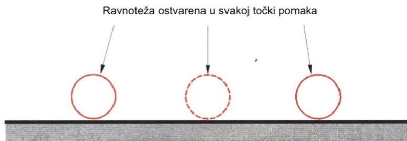
Slika 2. Neutralna statička stabilnost, [1]
