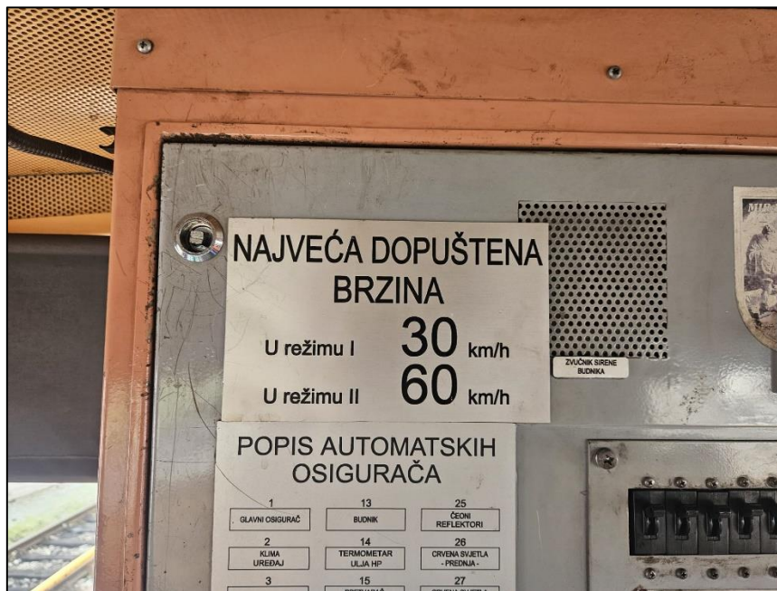
Slika 5. 1 . Najveće dopuštene brzine dizel manevarske lokomotive HŽ serije 2132-300
