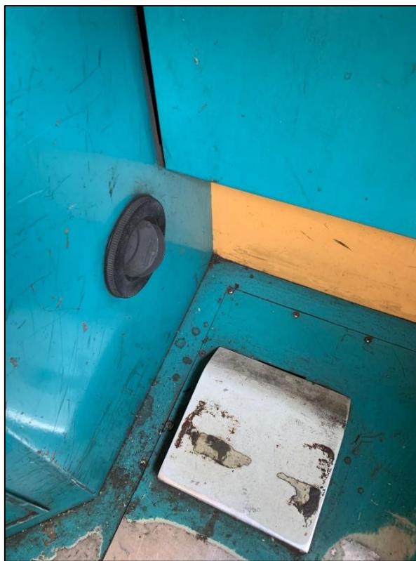
Slika 5. 12 Otvori za grijanje dizel manevarske lokomotive HŽ serije 2132-300
