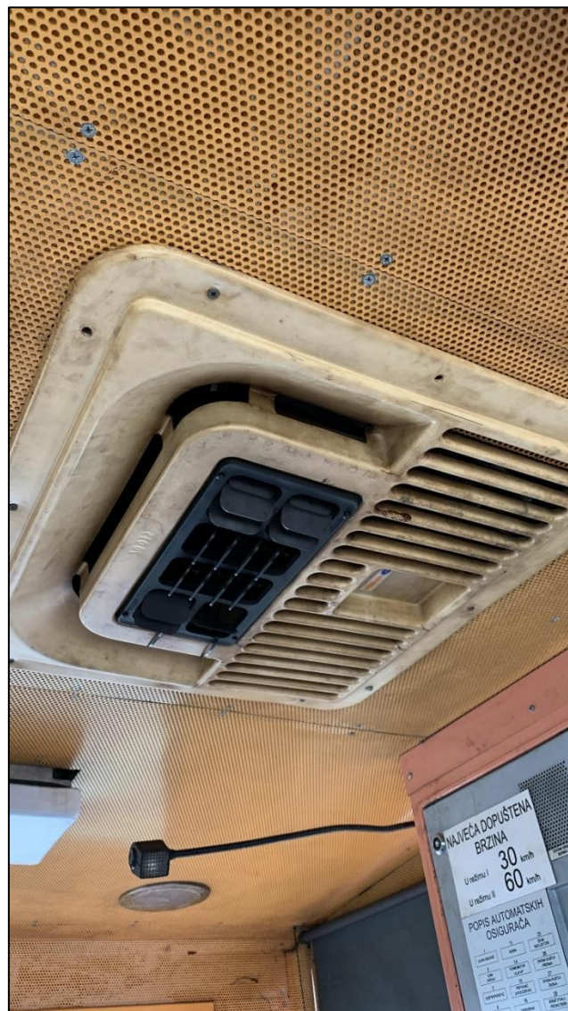
Slika 5. 11 Klima uređaj dizel manevarske lokomotive HŽ serije 2132-300
