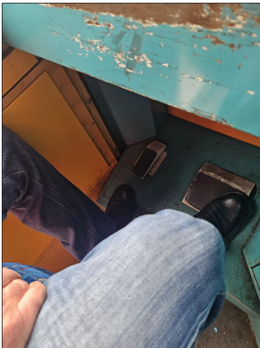
Slika 5. 7 Sirena (lijeva pedala) i budnik (desna pedala)
