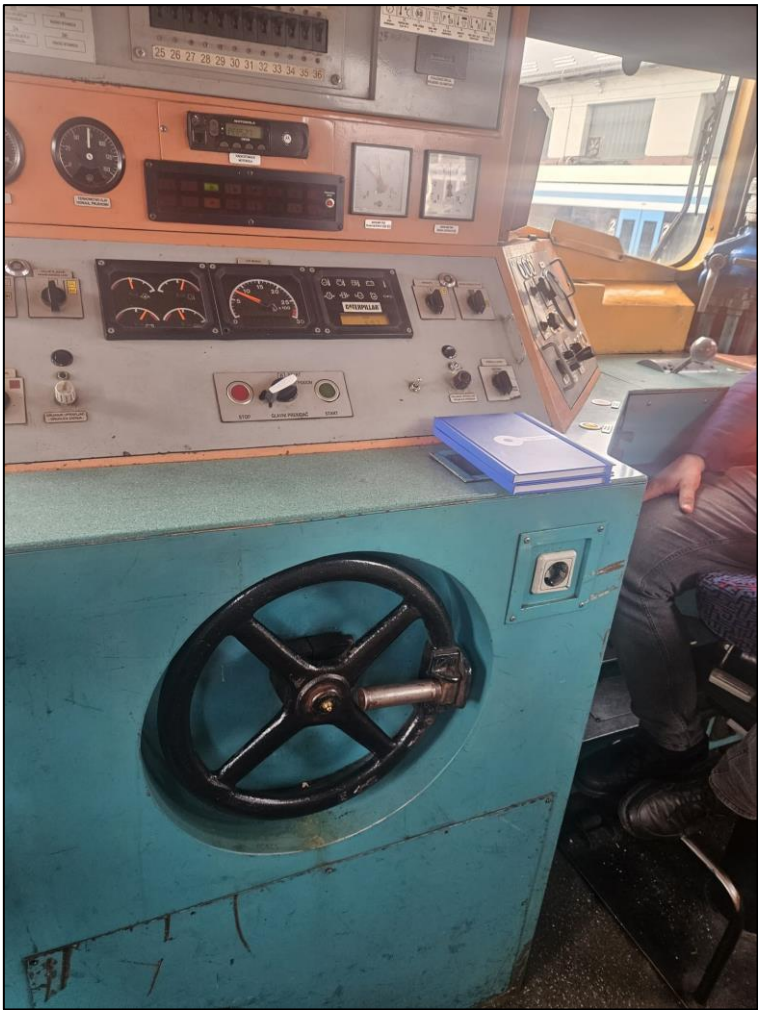
Slika 5. 3 Ručna kočnica dizel manevarske lokomotive HŽ serije 2132-300 otkočenom položaju
