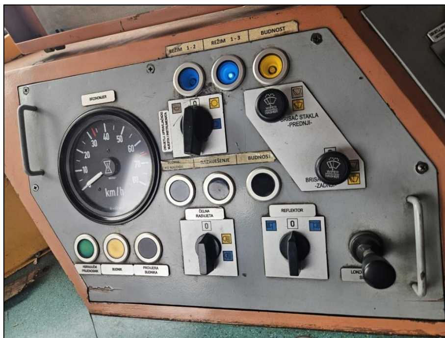
Slika 5. 9 Pult s najčešće korištenim komandama
