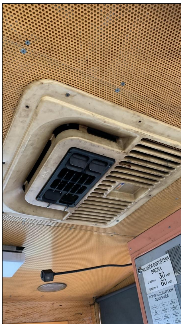
Slika 5. 11 Klima uređaj dizel manevarske lokomotive HŽ serije 2132-300
