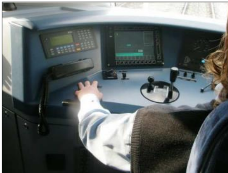
Slika 2. 2 Ručica višenamjenskog kontrolera s tasterom za budnik i manje ručice za promjenu smjera kretanja u normalnom doseg u lijeve ruke (točno ispred lijevog ramena vozača)
