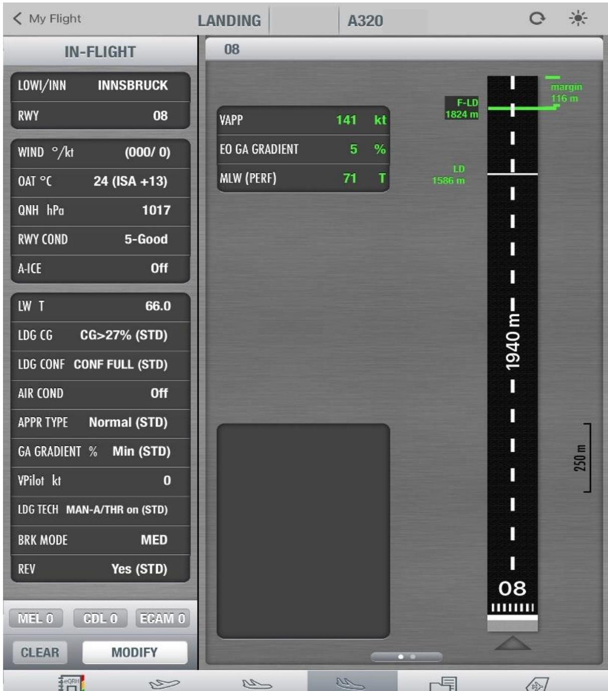
Slika 20. Izračun performansi na slijetanju - INN RWY 08 JUL
