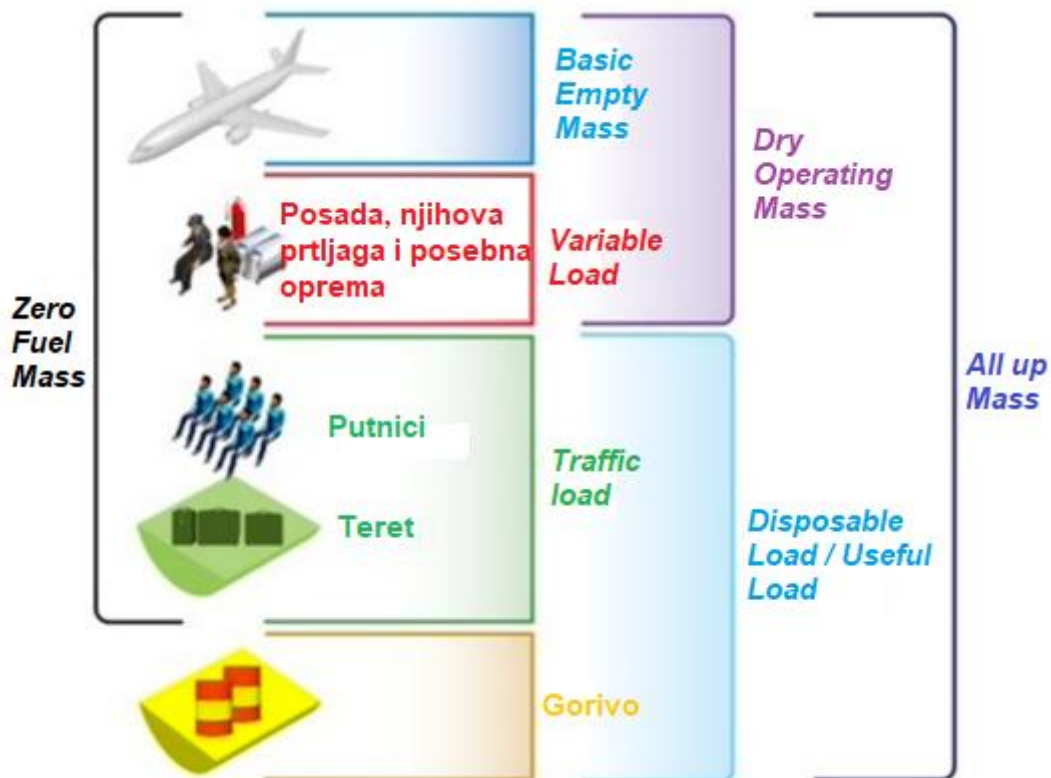
Slika 3. Vizualni prikaz različitih pojmova masa zrakoplova (adaptirao autor) [6]
