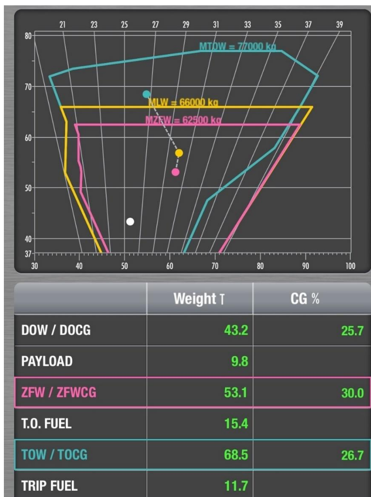
Slika 37. Prikaz pozicije centra težišta grafički i tablicom
