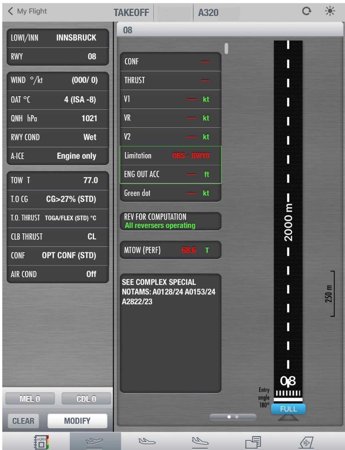
Slika 15. Izračun performansi uzlijetanja - INN RWY08 DEC
