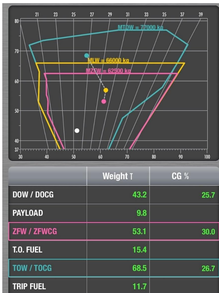
Slika 37. Prikaz pozicije centra težišta grafički i tablicom
