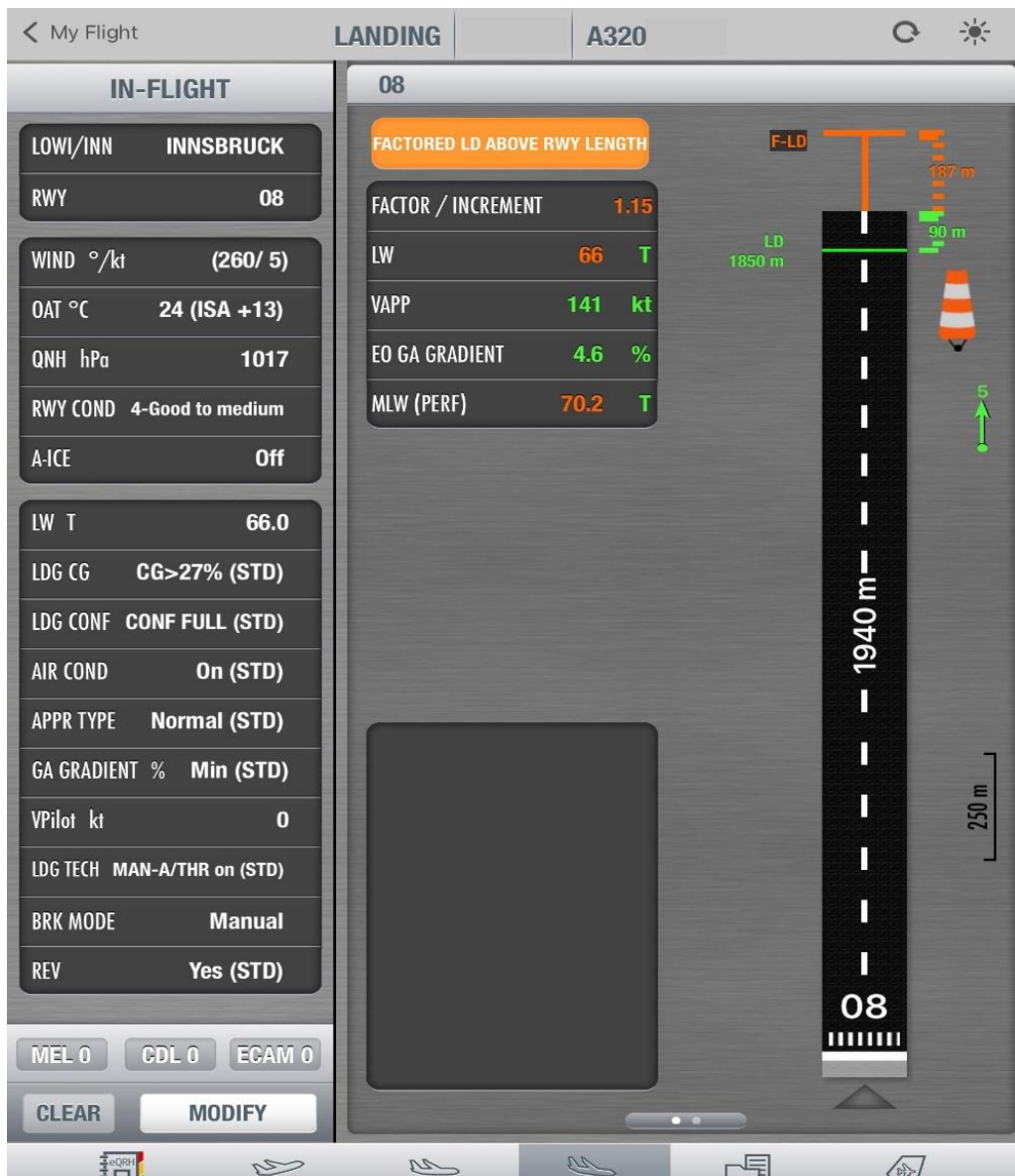
Slika 22. Izračun performansi na slijetanju s 5 kt leđnog vjetra - INN RWY08 JUL
