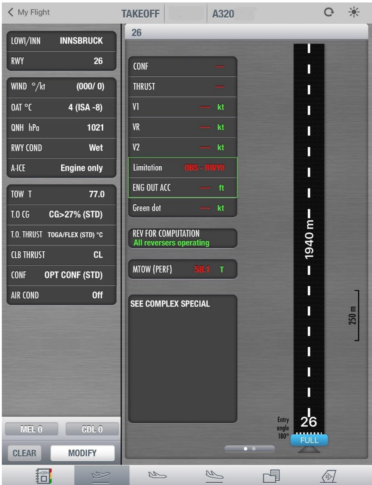
Slika 16. Izračun performansi uzlijetanja - INN RWY26 DEC
