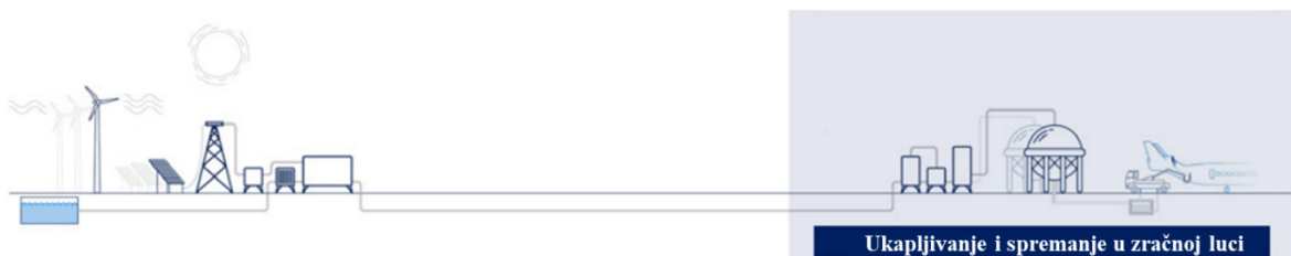
Slika 8. Scenarij 2, vodik proizveden van zračne luke, isporučen plinovodom i ukapljen u zračnoj luci Izvor: [32]
