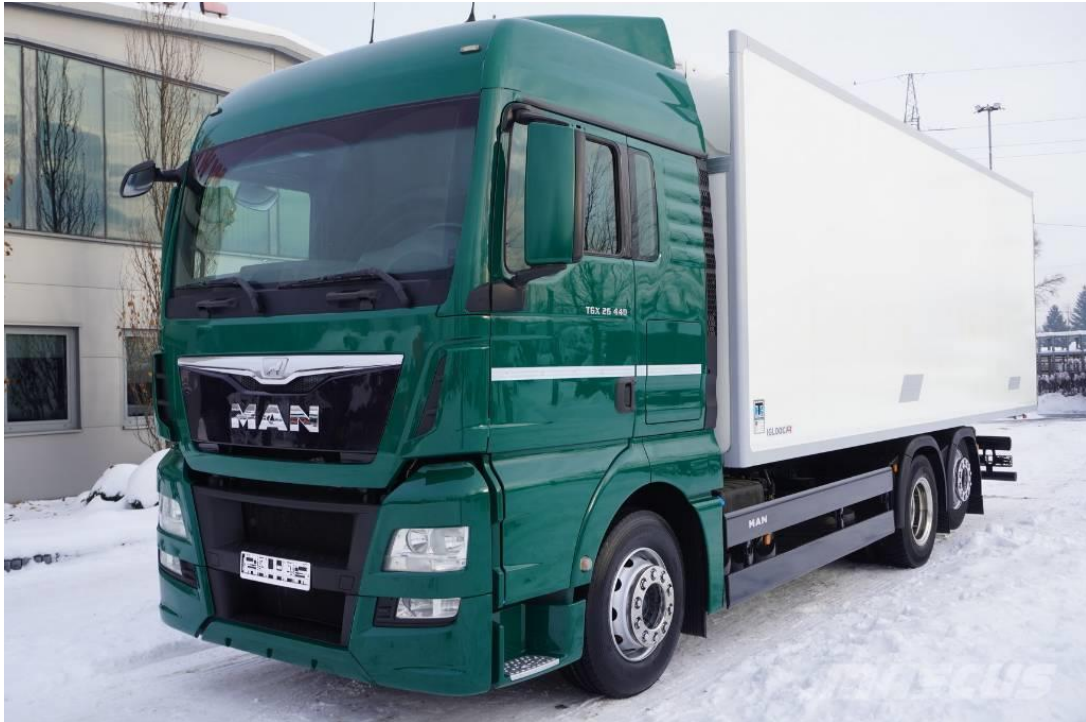
Slika 6. Kamion bez prikolice s tri osovine
