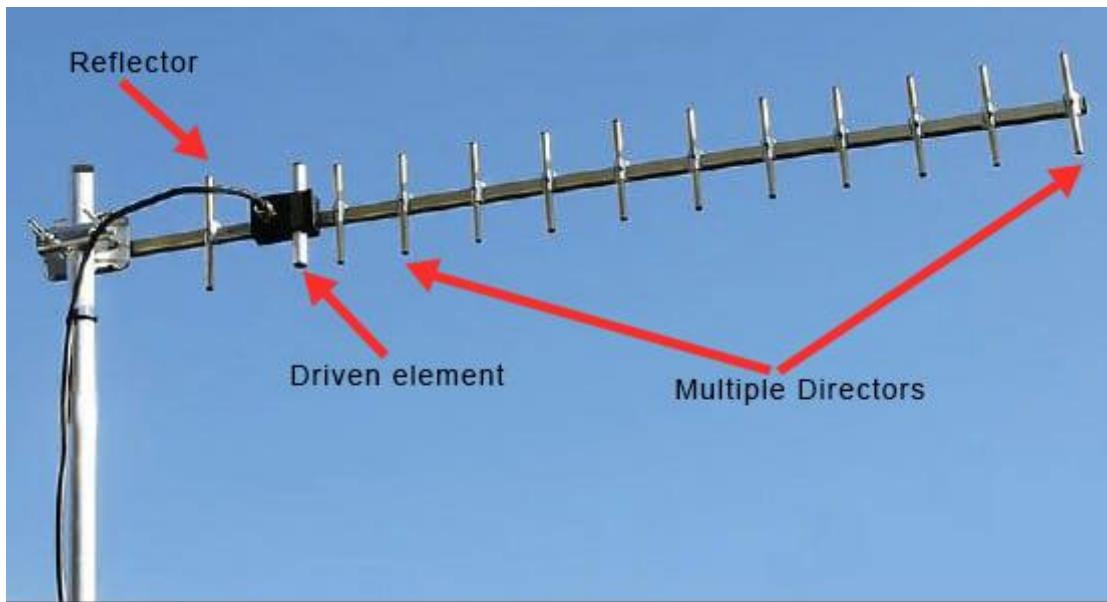
Slika 5: Yagi-Uda antena
