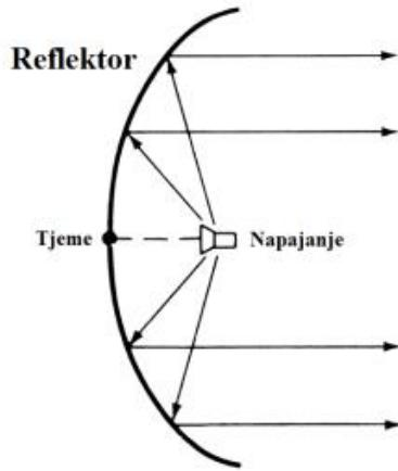
Slika 8: Parabolni reflektor
