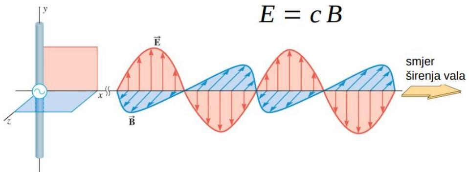
Slika 10: Elektromagnetski val
