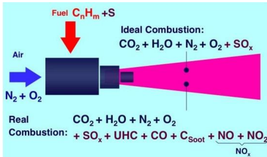
Slika 2 Produkti pri idealnom i stvarnom izgaranju [6]
