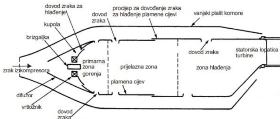
Slika 1 Konvencionalna komora izgaranja [5]
