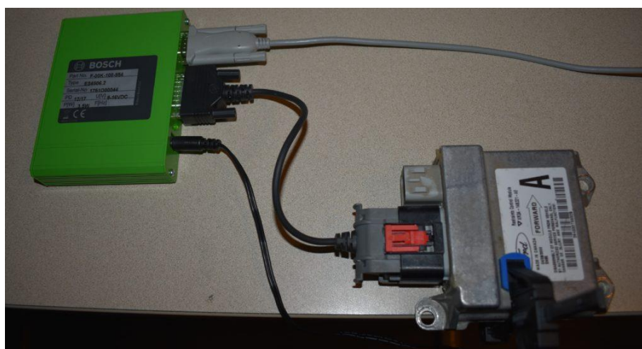
Slika 25: BOSCH Crash Data Retrieval pohranjivanje načinom Direct-To-Module Izvor: [19]
