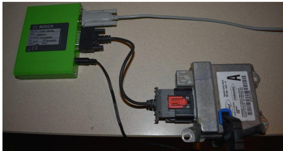
Slika 25: BOSCH Crash Data Retrieval pohranjivanje načinom *Direct-To-Module*
